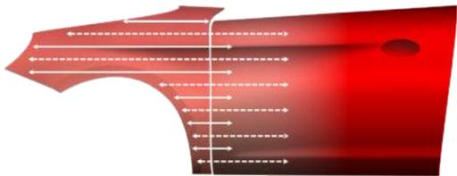
Difuminar la base bicapa Standox utilizada. Seguir las indicaciones de la Ficha Técnica de la calidad de base bicapa correspondiente para el proceso de difuminado recomendado. Dejar evaporar o secar la base bicapa según la Ficha Técnica.
