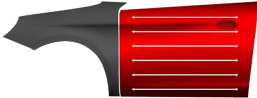
Preparar la pieza a reparar y difuminar según la Ficha Técnica del aparejo y de la calidad de base bicapa Standox utilizados. Lijar el aparejo a máquina con P500-P600. Lijar la zona de difuminado con P1000-1200. Limpiar la superficie suficientemente antes de aplicar la calidad de base bicapa Standox correspondiente.
